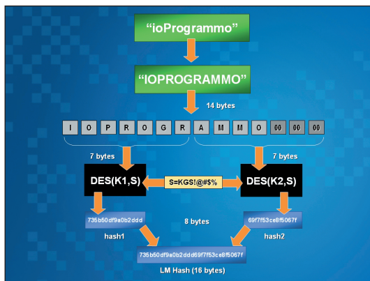
Fig. 6: Schema di funzionamento logico dell'algoritmo LM Hash. I problemi di sicurezza di questo algoritmo sono sotto gli occhi di tutti.
